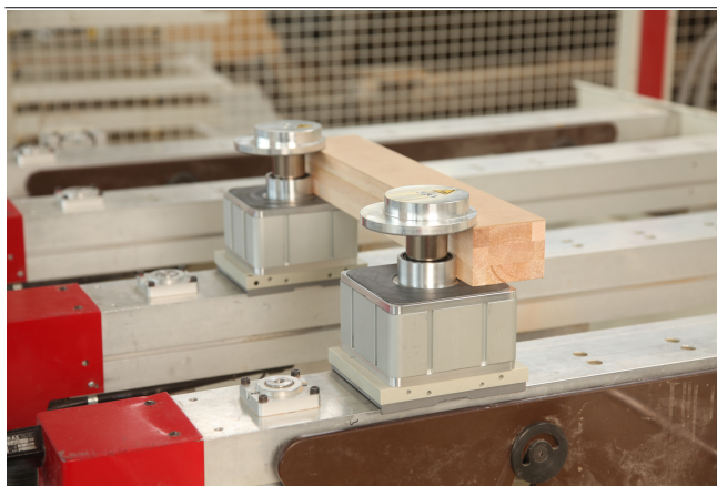
Blocs de bridage VCMC-K2 pour le bridage d'éléments de cadre
